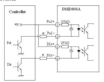
VCC=5V R=0 VCC=12V, R=1K $\Omega$  ( $\geqslant$ 1/8W) VCC=24V, R=2K $\Omega$  ( $\geqslant$ 1/8W)
