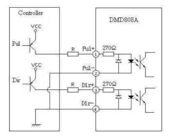
VCC=5V R=0 VCC=12V, R=1K $\Omega$  ( $\geqslant$ 1/8W) VCC=24V, R=2K $\Omega$  ( $\geqslant$ 1/8W)
